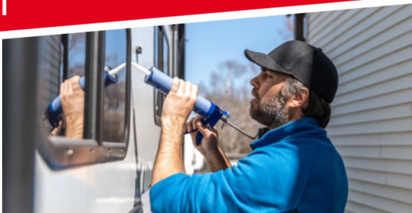
Damit verklebte oder eingedichtete Stellen am Camping-Fahrzeug extra lange halten, müssen Sie die entsprechenden Flächen gründlich reinigen und vorbereiten. Anhaftungen, Staub, Öl, Fette, Rost, Trennmittel und ältere Kleb-Dicht-Reste dürfen nicht mehr vorhanden sein. **Außerdem ist es immer gut, wenn Sie wissen:**
